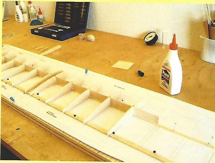
Die Verkastung ist schon sorgfältig zugeschnitten. Rippe und Verkastung werden abwechselnd eingeklebt, das spart Zeit
