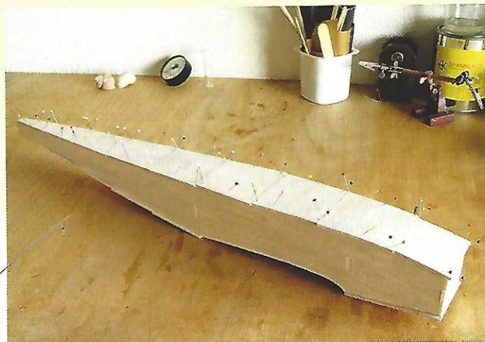
Rumpfrücken und -boden werden mit solidem 3-mm-Balsa beplankt. Eine GFK-Beschichtung des Rumpfes ist für den Vielflieger dennoch ratsam.
