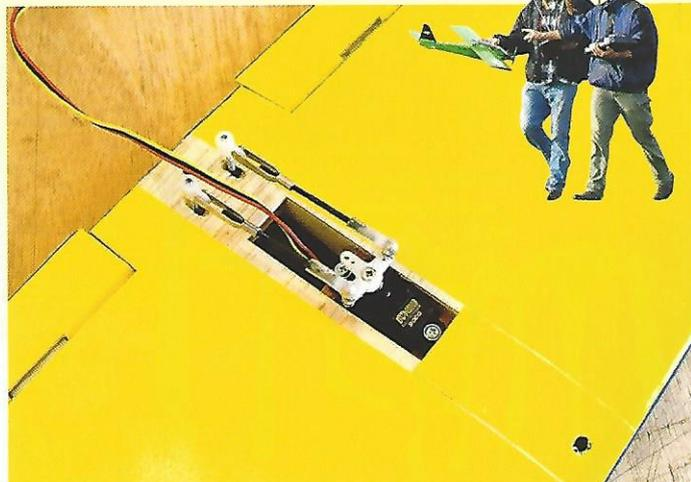
Flächenunterseite: Die Querruder werden mit einem Zentralservo angesteuert
