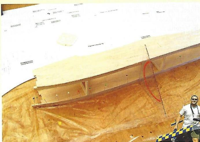
Mit einem Geodreieck kann man die exakte Ausrichtung der Rumpfsseiten überprüfen
